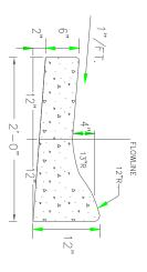
TYPE 4 CONCRETE ROLLED CURB & GUTTER N.T.S.
